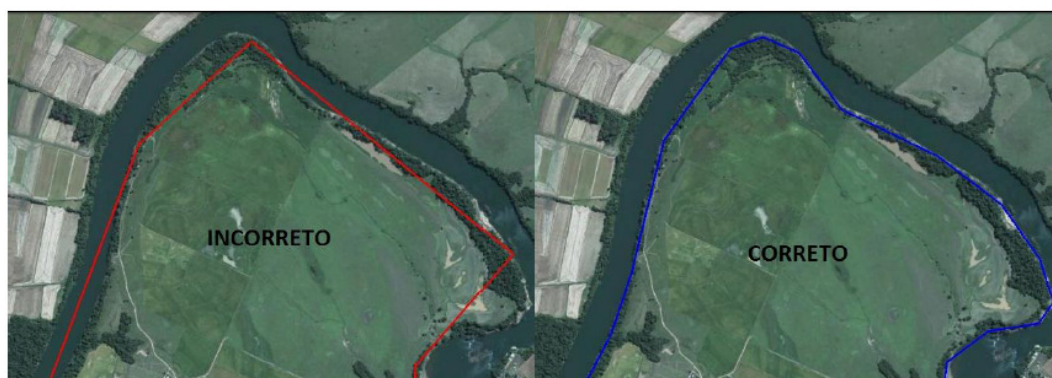
Figura 1: Situação incorreta e correta no mapeamento de divisas naturais definidas por curso d'água. Fonte: INCRA (2013).
